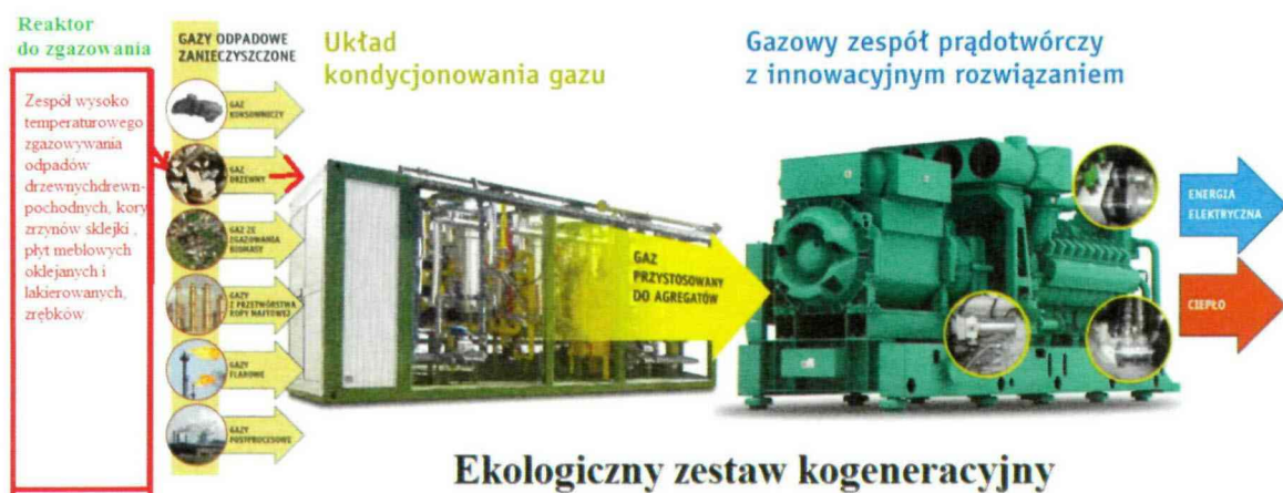
Zespół zgazowania i wytwarzania prądu i ciepła 300
